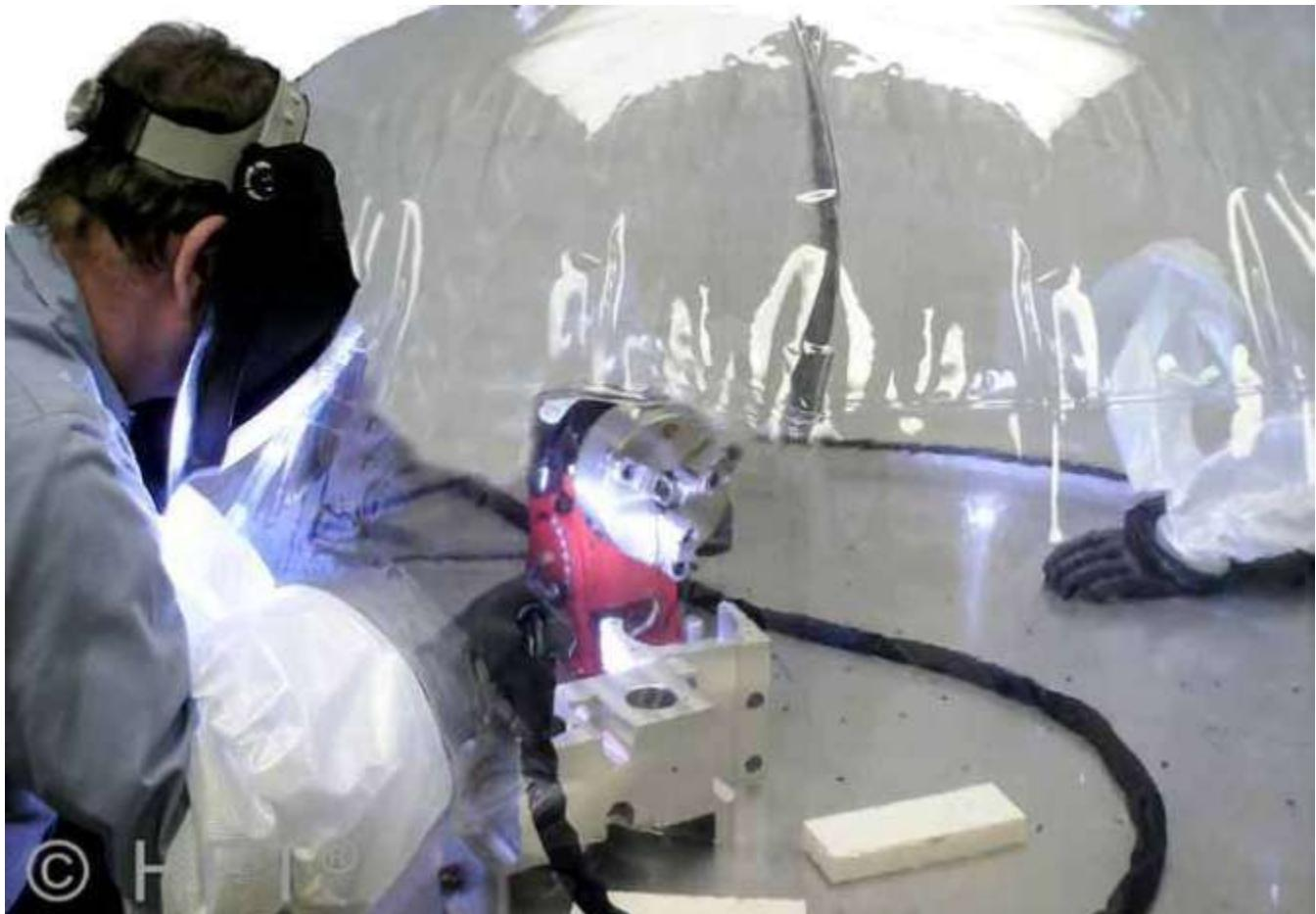
Las cámaras® de purga flexibles Argweld® se han diseñado para aplicaciones donde una cámara rígida no fuera económicamente viable o donde el espacio es limitado.
